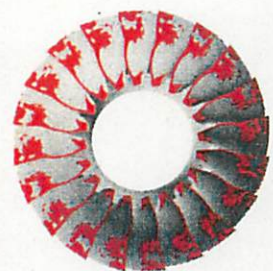
図4：動翼前縁のはく離の様子
