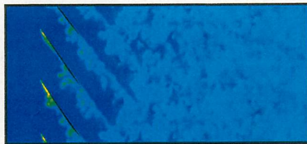
図3：動翼単体でのCFD結果 (TIP 近傍 span)
