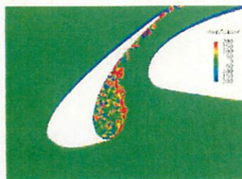
図3：試行形状の渦度コンター。迎角 5.5 度。
