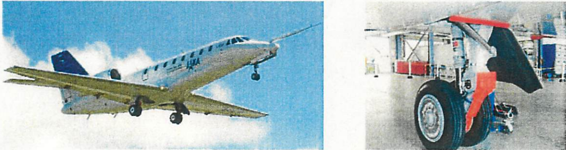
図1 2017年飛行試験形態(フラップを収納し、脚のみ展開した状態)
